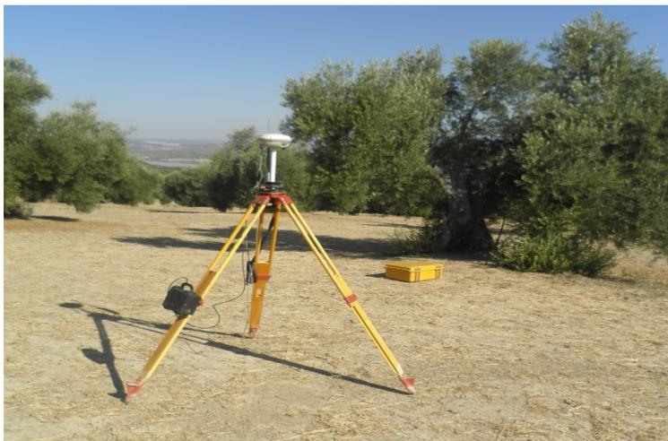
El método de observación ha sido el tiempo real RTK utilizando correcciones diferenciales transmitidas por las Estaciones GPS de la RAP (Red Andaluza de Posicionamiento), de modo que se observa un vector de incrementos de coordenadas entre dos estaciones  $D_x$ ,  $D_y$ , y  $D_z$ , respecto de un sistema de referencia global geocéntrico (ETRS89).
